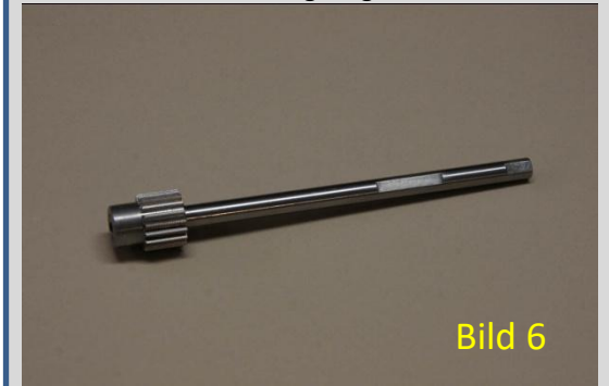
Zwischenwelle mit Stirnzahnrad als Alternative zu Vario bzw. Mädlar Teilen wenn keine eigene Bearbeitung möglich ist
